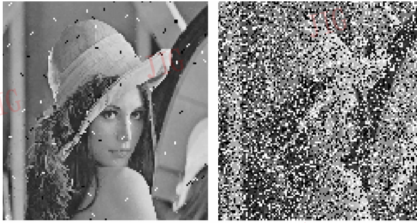
(a)传统的稳健平滑滤波算法的滤波效果(分别用3×3, 9×9模板)
